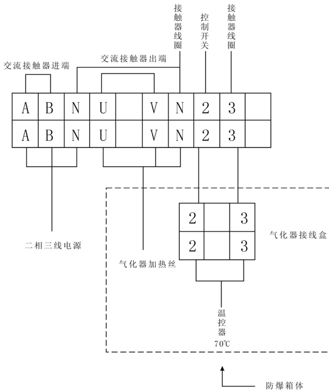
BESTEx-C 型电器接线原理图 (100-300kg/h)
